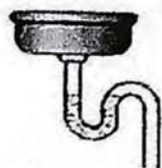
B. 排水管的U形“反水弯”
