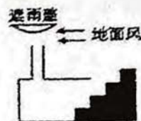
D. 地下通道的自动抽气设计
