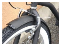
C. 刹车皮采用橡胶材料
