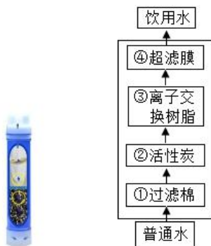
图1生命吸管 图2生命吸管净化过程
