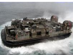
D. 压缩空气使气垫船船体与水面脱离接触
