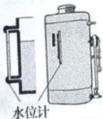
B. 锅炉水位计显示水位
