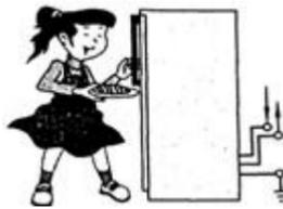
将冰箱的金属外壳接地
