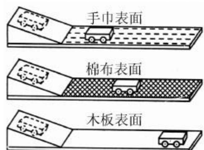
16. (12分)在探究摩擦力的大小与什么因素有关的实验中,选用的器材有:正方体木块,读数准确的弹簧测力计,粗糙程度均匀的长木板等.
