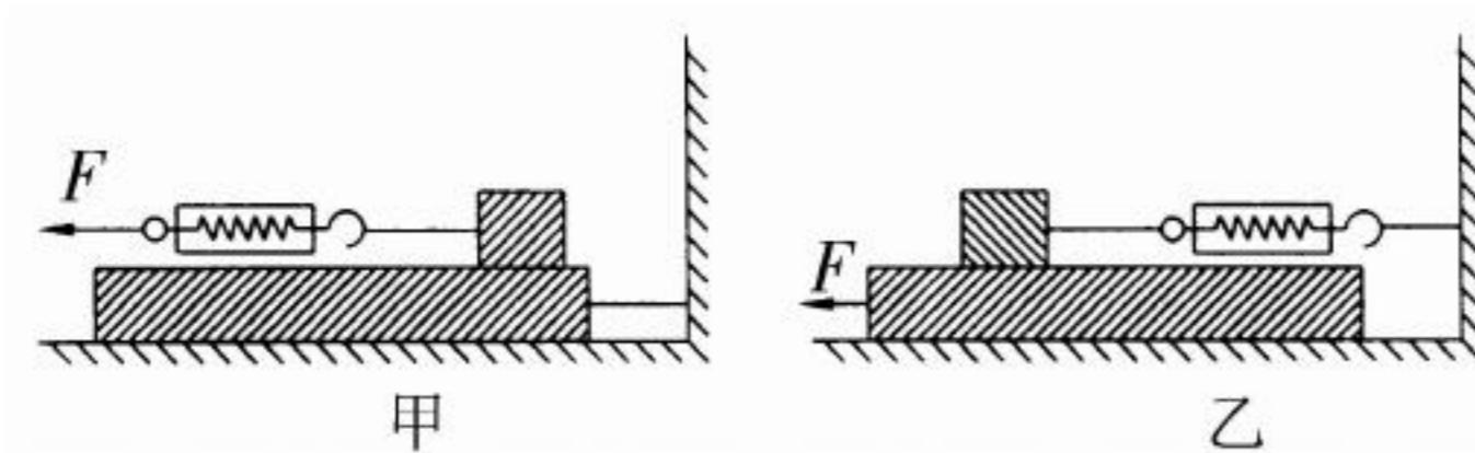
(1)采用如图甲所示的实验装置测量木块与长木板之间的摩擦力时,发现弹簧测力计示数不稳定,很难
