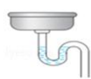
A. 用回水管的“水封”阻隔臭气
