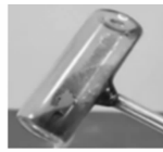
B. 用酒精灯加热碘管,管中出现“紫气”
