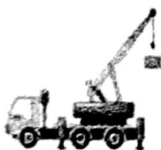
A. 吊起货物时，起重机的吊臂相当于费力杠杆
