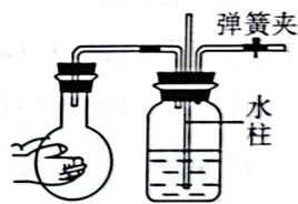
D. 检查装置的气密性
